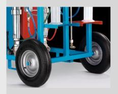
**Praktische Fahrgestelle** für häufig wechselnde Einsatzorte der Applikationsanlagen. Durch die kompakte Bauweise auch für schmale Zufahrten und Türen geeignet. Für den ausschließlich stationären Einsatz empfehlen wir WIWA Wandhalter oder Standgestelle.
