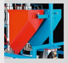
**Stabile Zulauftrichter** mit einem Fassungsvermögen von ca. 25 l eignen sich ideal für Materialien, die nur in Kleingebinden lieferbar sind. Ihre optimierte Gehäusegeometrie ermöglicht eine effiziente Materialzuführung und die optimale Reinigung des Trichters.
